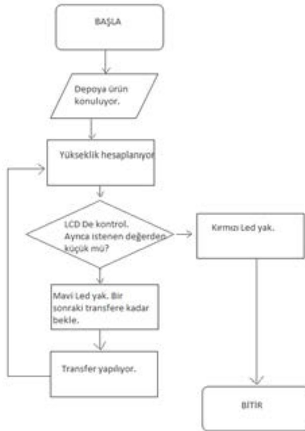
Şekil 3. Sistemin çalışmanın Algoritması.
