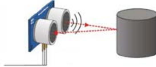
Şekil 4. Ultrasonik sensör çalışma prensibi [10]
