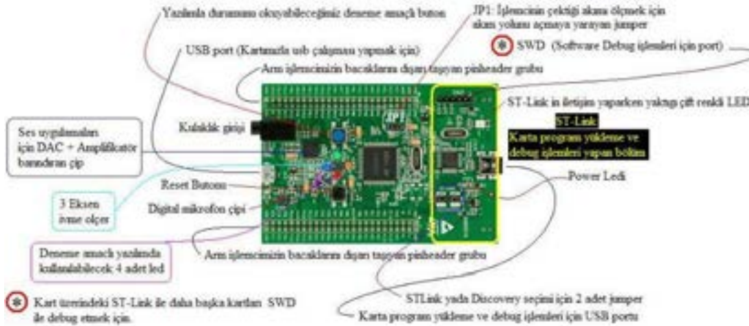
Şekil 7. STM32F4 Discovery Kiti [13]
